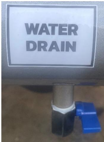
Se encuentran (4) válvulas de drenaje de agua instaladas. Estas se encuentran ubicadas en el tanque, las barras de rociado y la bomba de agua. Estas se utilizan para drenar el agua después de su
