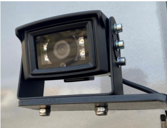
Ubicada en la parte trasera del tanque, cuando está en reversa, la cámara de retroceso mostrará la vista detrás del vehículo en la pantalla del tablero.
