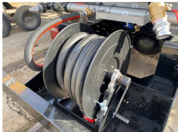
Normalmente ubicado en la parte trasera inferior del vehículo, equipado con una manguera de goma de 50 pies y 1 1/2 pulgadas de diámetro con una boquilla de estilo de giro. Se encuentran disponibles enrolladores eléctricos y manuales.
