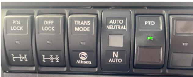
Controles de la Toma de Fuerza (PTO) en el tablero de instrumentos
