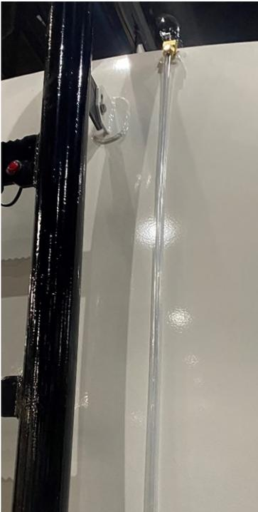
Ubicado tanto en la parte delantera como en la trasera del tanque, es un tubo transparente que muestra el nivel de agua dentro del tanque. El tanque debe estar al menos 1/4 lleno para operar las funciones de agua.
