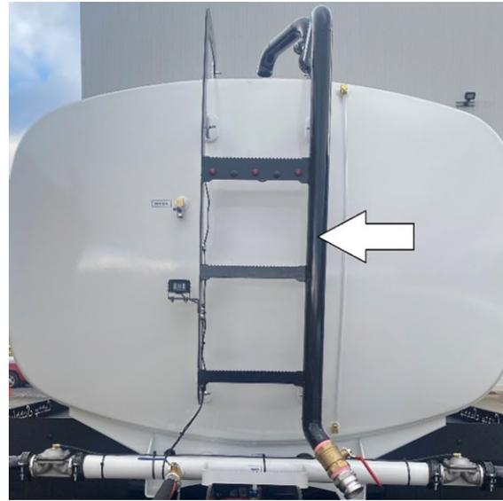
Ubicado en la parte trasera del camión, el tubo de llenado es la principal fuente para llenar el tanque con agua. El agua viaja por este tubo hasta una abertura en la parte superior del tanque, llenándolo de agua.
