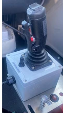
Se encuentra localizado dentro de la cabina, la palanca de mando permite al operador manejar el cañon en diferentes direcciones y controlar la cantidad de agua. El cañon de agua puede rotar horizontal o verticalmente.
