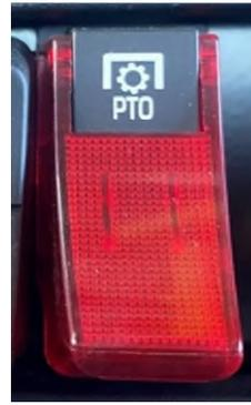
En los Modelos Ford el control se encuentra con cubierta roja (izquierda). Presione la parte superior del botón, encienda el "Modo Estacionario". Levante la cubierta roja y presione la parte inferior del botón activando el "Modo Móvil".
