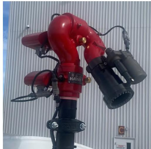
Ubicado en la parte superior del camión, entre el tanque de agua y la cabina, proporciona la capacidad de rociar agua en lugares precisos mediante la rotación tanto horizontal como vertical. Es controlado por una palanca de mando dentro de la cabina.
