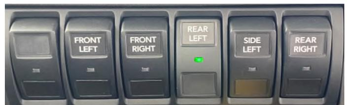
Ubicados dentro de la cabina, estos controles abren y cierran los cabezales de rociado. Hay dos paneles de control diferentes que vienen de serie con los camiones cisterna de Curry Supply.
